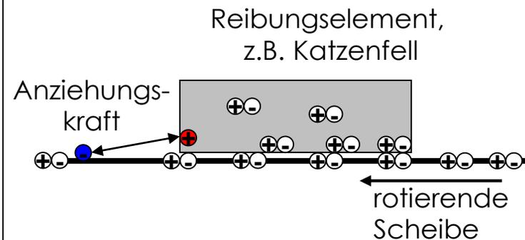
Statische Aufladung entsteht, wenn positive und negative Ladungen durch Reibung getrennt werden. Beim Trennen der Ladung muss aber Arbeit gegen die Anziehungskraft zwischen den Ladungen geleistet werden!
