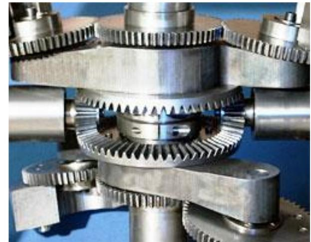
Die Gewichte (dunkel) werden über ein Zahnradgetriebe in dem Moment nach außen bewegt, in dem sie die maximale Vorwärtsbewegung aufweisen. Nach einfacher mechanischer Überlegung erhöht dies lediglich das Trägheitsmoment der Gesamtanordnung und die Vibrationsbelastung der Achse. Auf eine mögliche Energiegewinnung mit dieser Anordnung nimmt die Patentschrift auch keinen Bezug, sondern auf Speicherung von Rotationsenergie.
