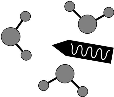
2. UV-Quant wird von einem Wassermolekül absorbiert, dieses geht in angeregten Zustand über
